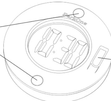
**Taste 1** – Öffnet die Abdeckung auf der Rückseite.
